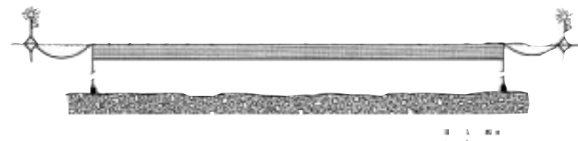
Figure 34 : Filet de lève. Filet de surface utilisé en accouplant trois pièces de 100 m de long chacune ancrées à chaque extrémité.
