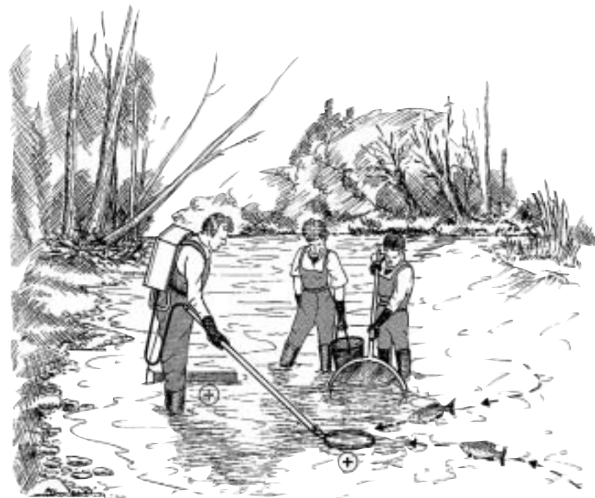
Figure 104 : Pêche électrique. Exemple d'un matériel portable. L'anode (+) attire le poisson, qui est capturé avec une épissette et stocké dans un seau. Pour des raisons de sécurité cette pêche ne peut pas se pratiquer seul et tous les membres de l'équipe de pêche doivent porter des équipements isolants.
