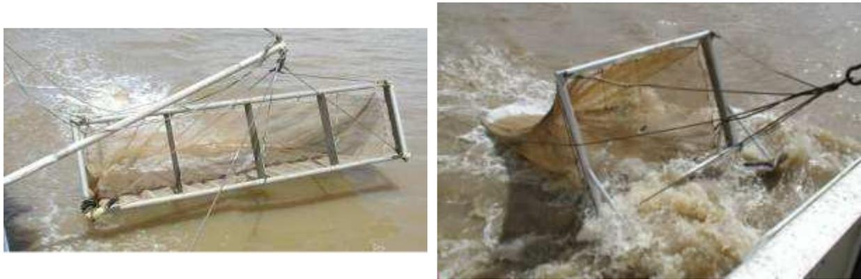
Figure 10. Vues du cadre d'échantillonnage de surface bâbord avant son immersion (à gauche) et du cadre arrière avant son immersion (à droite)
