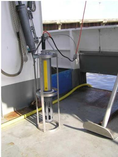
Figure 11. La sonde multiparamètres YSI
