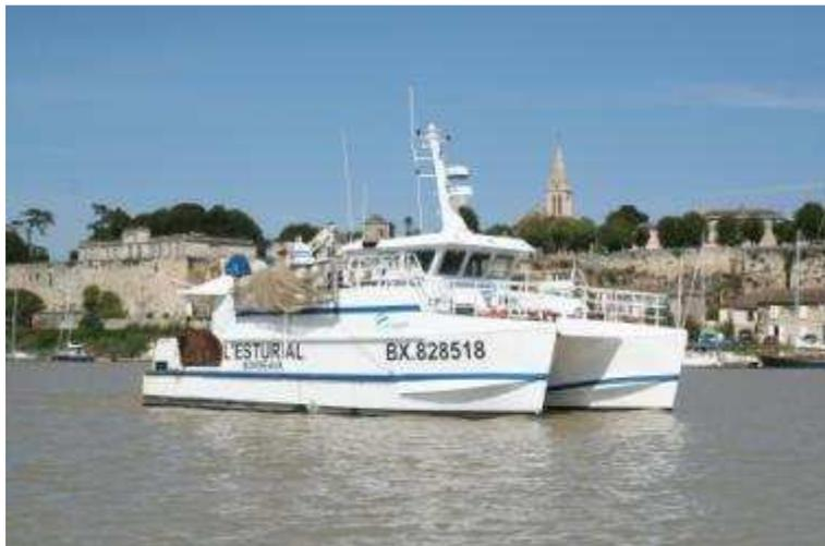
Figure 9. L'ESTURIAL, navire de recherches estuariennes d'Irstea, mis en service en septembre 1993, rénové et allongé en 2009.
